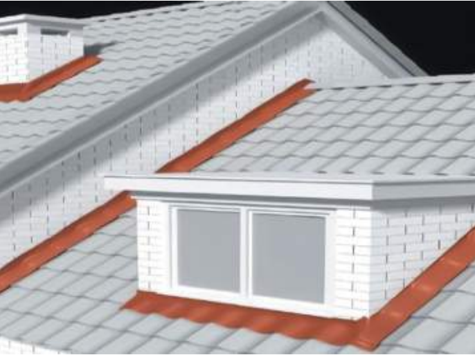
PASUL 8 Etanșare adițională cu Tondach Bară etanșare horn/perete. Tondach bară de etanșare horn/perete se va fixa cu holșuruburi. Îmbinările se pot sigila cu silicon pentru construcții. Atât banda cât și bara de etanșare se pot folosi împreună pentru etanșarea tuturor situațiilor exemplificate în imaginea de prezentare de mai jos – marcaj culoare portocaliu.
